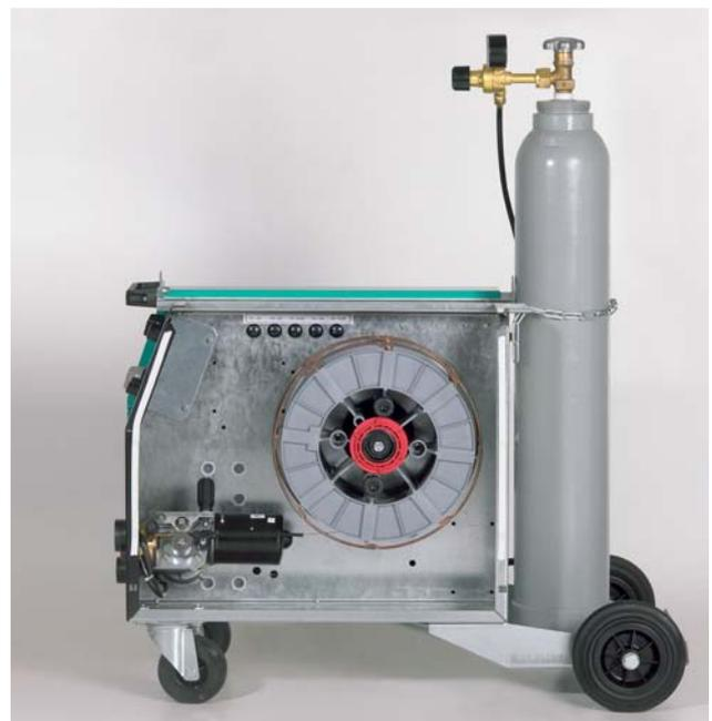
Drahtvorschubsystem und Drahtspule sind übersichtlich und leicht zugänglich angeordnet.
